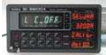
캘리브레이션이 완료되었습니다. 전면의 CAL S/W를 OFF하십시오
